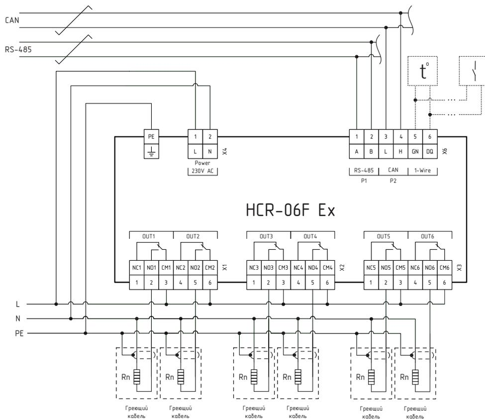
Пример подключение к трехфазной сети с использованием нормально замкнутых контактов
